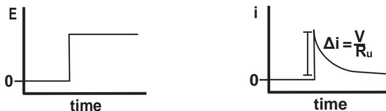
图 5. 位阶跃的施加电位波形（右）和电流曲线（左）。初始电流尖峰等于  $V/R_u$
